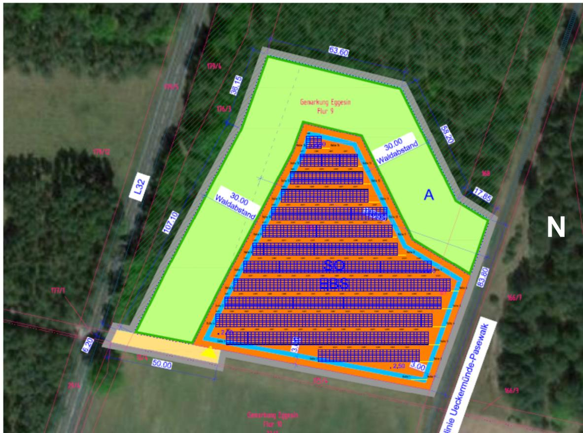
Abbildung 1: Satellitenbild mit Modulbelegungsplan des Anlagenstandortes
